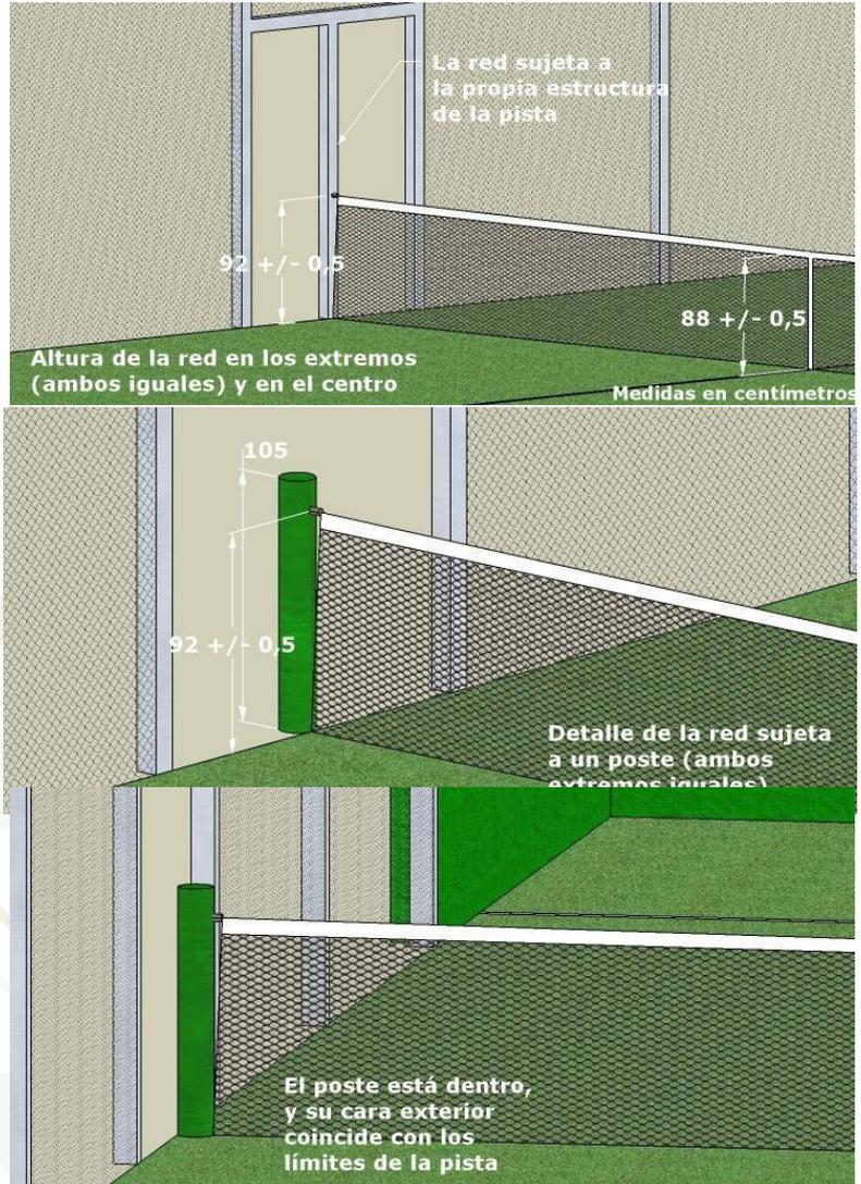
Los postes de la red tienen sus caras exteriores coincidiendo con los límites laterales de la pista (abertura, puerta o malla metálica). Pueden ser de sección circular o cuadrada pero tendrán sus aristas redondeadas.
