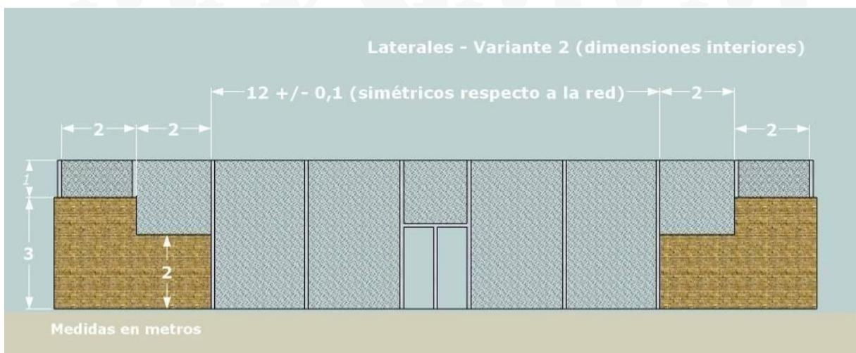
La malla metálica se coloca siempre alineada con la cara interior de las paredes. En el caso en que la malla metálica se encuentre fijada a un bastidor, la parte superior del mismo debe encontrarse libre de objetos extraños a su estructura metálica (ejemplo: cables, cajas de derivación eléctricas, artefactos de iluminación, etc.)
